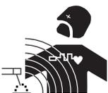
Der durch einen Leiter fließende elektrische Strom erzeugt lokale elektrische und magnetische Felder (EMV). Beim Betrieb von Lichtbogenschweißanlagen kann es zu elektromagnetischen Störungen kommen.
