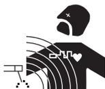
La corrente elettrica che attraversa un qualsiasi conduttore produce dei campi elettrici e magnetici (EMF) localizzati. La corrente di saldatura produce un campo elettromagnetico attorno al circuito di saldatura e al dispositivo di saldatura.
