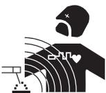
Elektrische stroom die door geleidend materiaal of kabels gaat veroorzaakt plaatselijk elektrische en magnetische velden (EMF). De lasstroom wekt een elektromagnetisch veld op rondom de laszone en het lasmateriaal.
