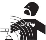
Prąd elektryczny przepływający przez jakikolwiek przewodnik wytwarza lokalne pola elektryczne i magnetyczne (EMF). Prąd spawania wytwarza pole elektromagnetyczne wokół obwodu spawalniczego i urządzenia spawalniczego.
